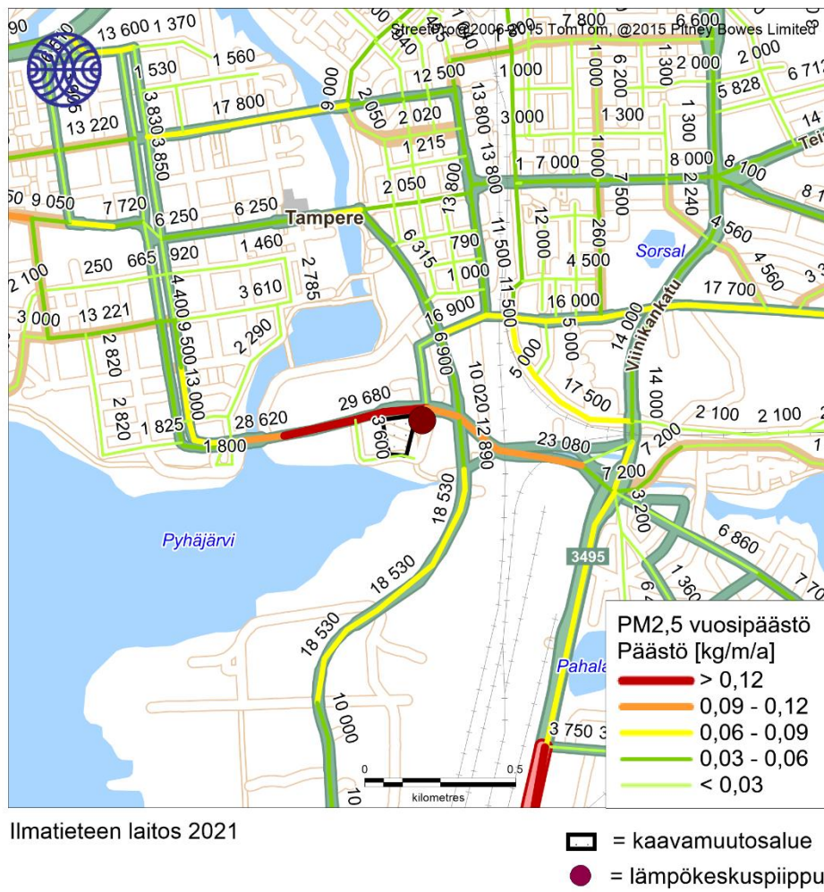
Kuva 5. Lämpökeskuspiipun ja kaavamuutosalueen sijaintikohdat sekä laskelmissa mukana olleiden katujen ja teiden autoliikenteen pienhiukkaspäästöt (kg/a/m) ja arkivuorokausien liikennemäärät (KAVL, ajoneuvoa vuorokaudessa) tutkimusalueella nykytilanteessa.
